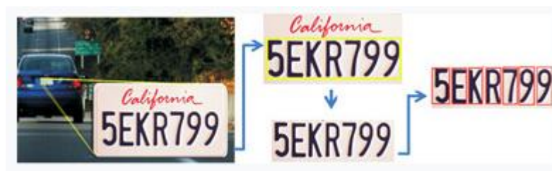
Рисунок 3 – Разбиение номерного знака на отдельные символы
