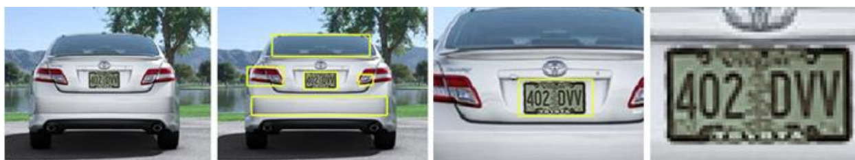
Рисунок 1 – Локализация номерного знака на изображении транспортного средства
