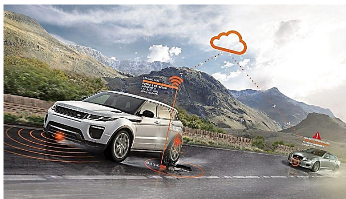
Рисунок 3 – Схема работы технологии Pothole Alert
