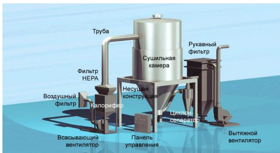
Рисунок 9 – Промышленная сушильная установка
