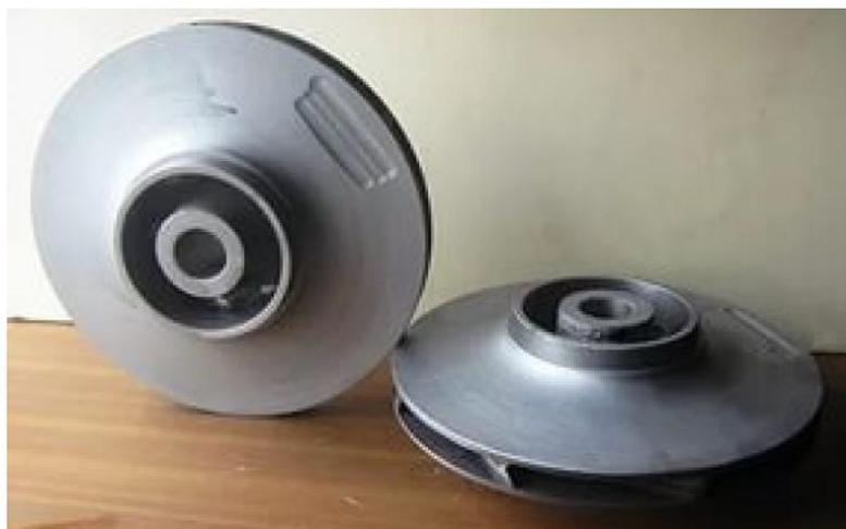
Рисунок 5 – Крыльчатка насоса
