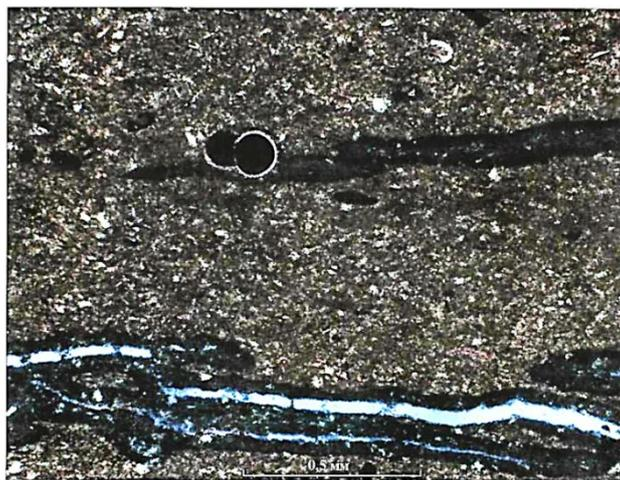
Рисунок 1 – Вид трещин на микрошлифе образца породы
