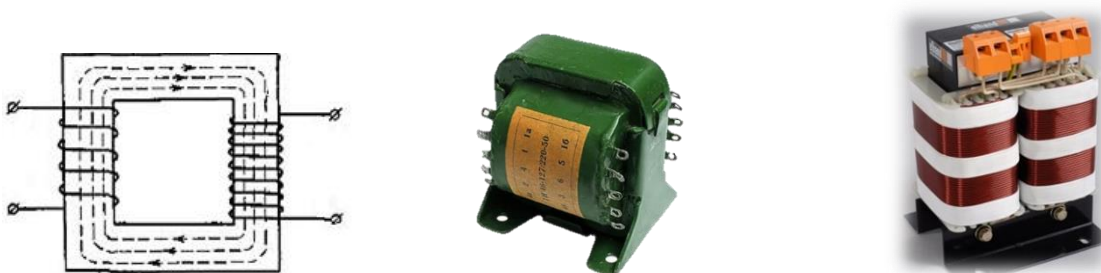
Рисунок 4 – Ленточный магнитопровод трансформатора
