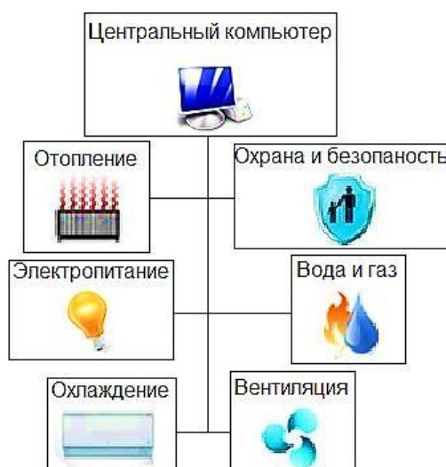
Рисунок 2 – Схема работы BMS (Building Management System)
