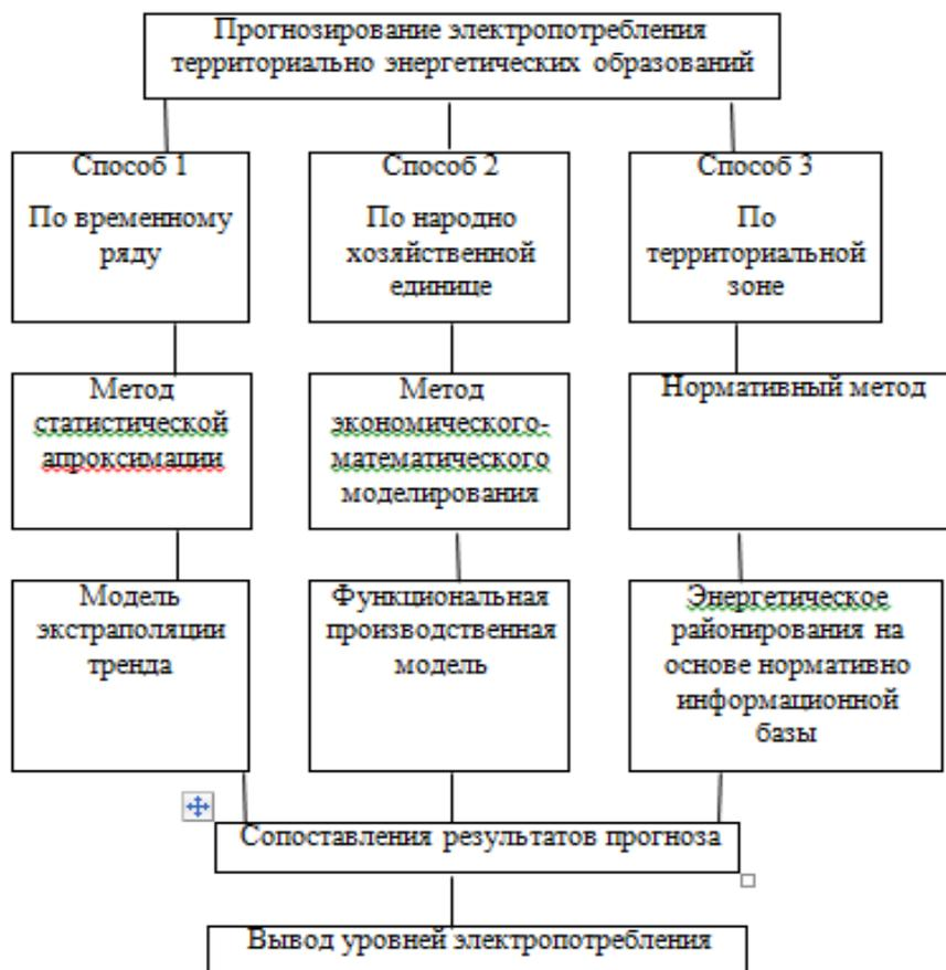
Рисунок 1 – Схема прогнозирования электропотребления территориально энергетических образований
