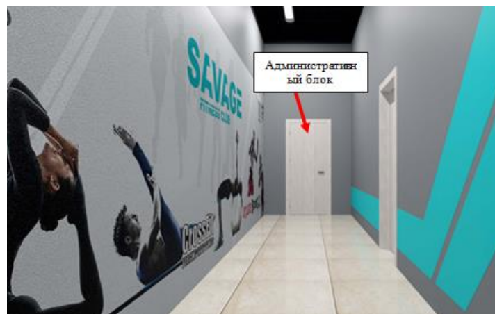
Рис. 8 – Обои с неустановленными показателями пожарной опасности
