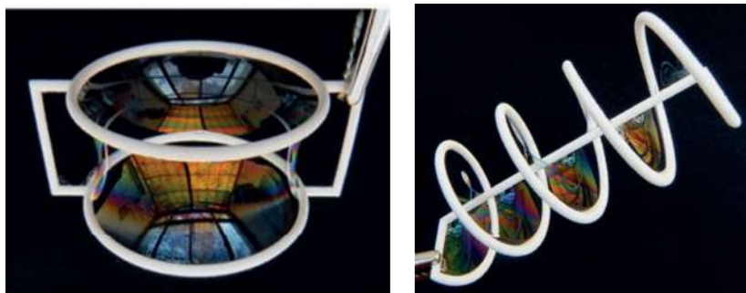
Рис.1. Модели контуров для образования катеноида (слева) и геликоида (справа); автор моделей Segerman H. [9]
