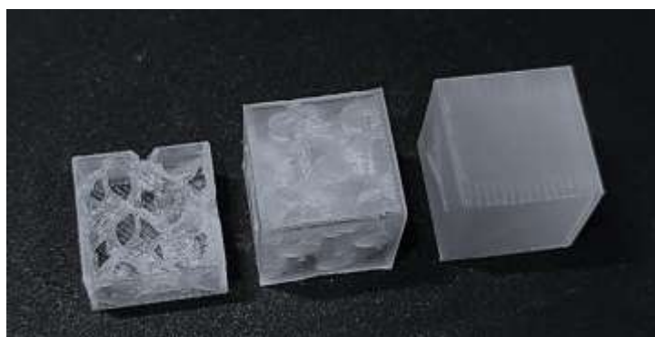
Рис.3. Кубики с полным заполнением (справа) и с гироидным заполнением (в центре и слева-в разрезе)
